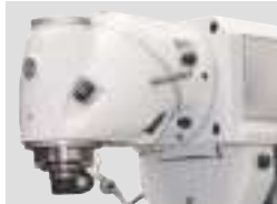
Cabezal de fresado · El cabezal de fresado tiene dos ejes giratorios, lo que significa que puede girar en cualquier ángulo espacial.
