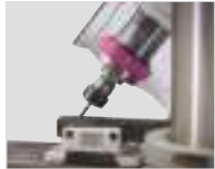
Cabezal · Inclinación lateral ±45°.
