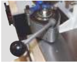
Portaherramientas de cambio rápido SWH 7-C de serie · Portaherramientas 32 x 130 tipo D para herramientas cuadradas de 25 mm.
